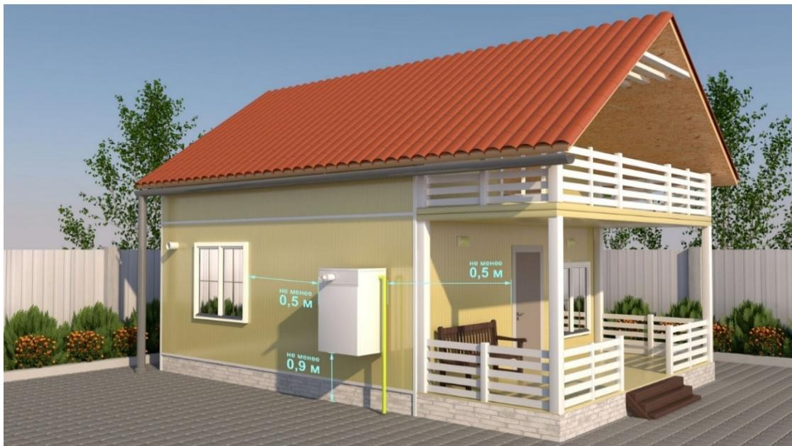
**Расстояние от дымохода до вентиляционных решеток на стене здания = 1,0 м;**
