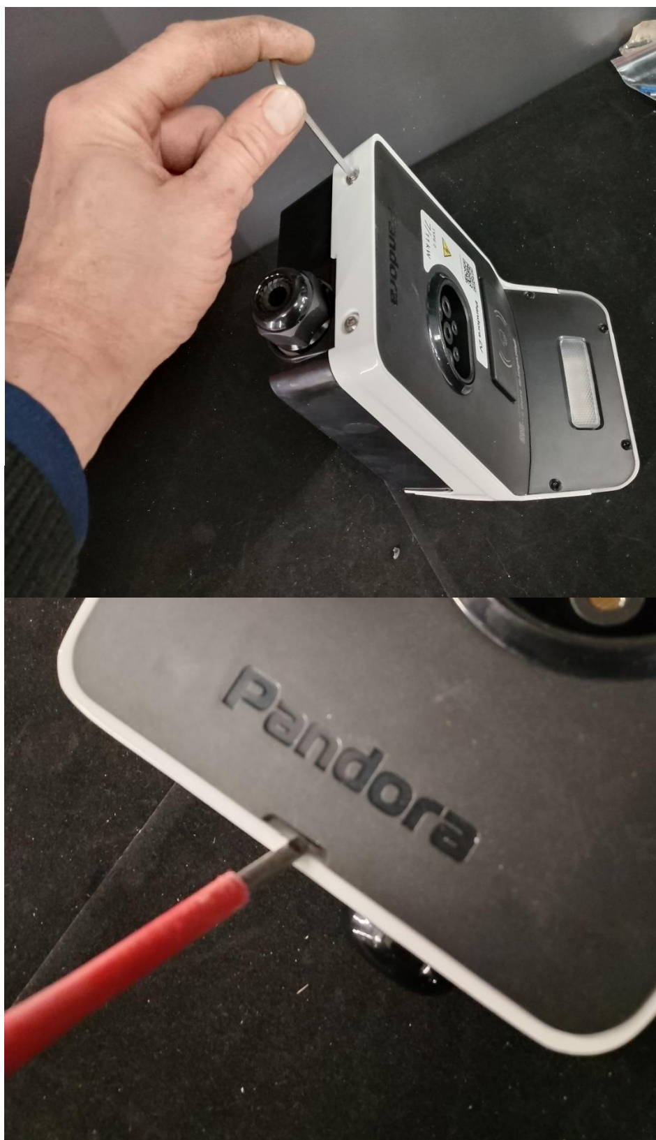
Рисунок 2. Снятие лицевой панели станции
