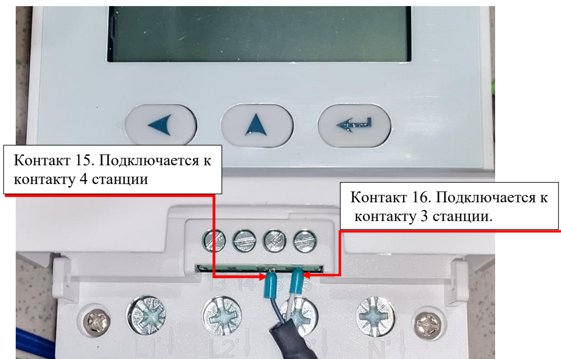
Рисунок 26. Подключение информационного кабеля к клеммам счетчика
